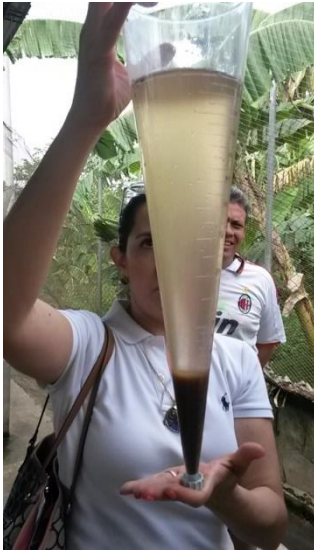
Figura 2. Cono Imhoff para sedimentación y medición de sólidos en suspensión
