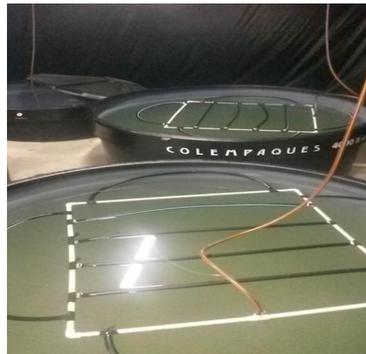
Figura 4. Parrillas con manguera poli-difusora para tanques plásticos de 4 m^3 cada uno.
