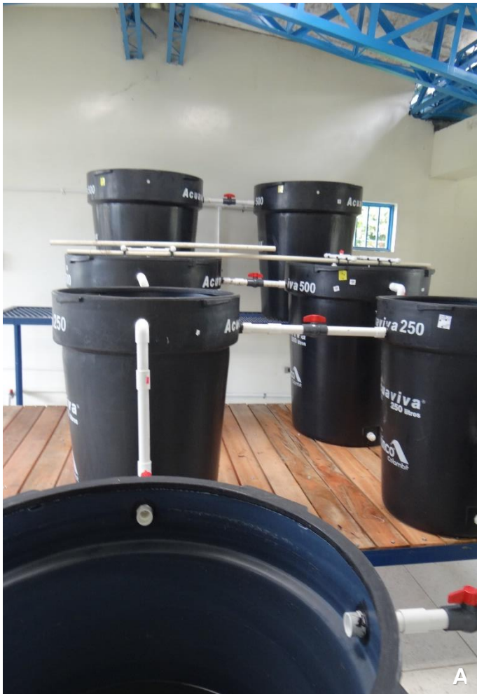
Figura 1. Infraestructura diseñada y construida para manejo de temperatura e incubación de ovocitos de doncella.
