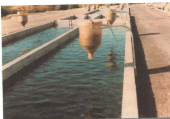
Figura 25. Autoalimentador para cultivos de peces.
