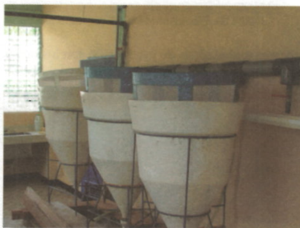
Figura 41. Incubadoras verticales tipo Woynarovich.
