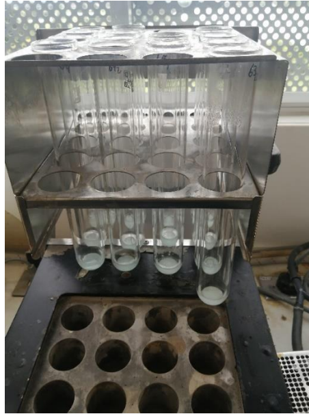
Figura 3. Digestión de proteína total
