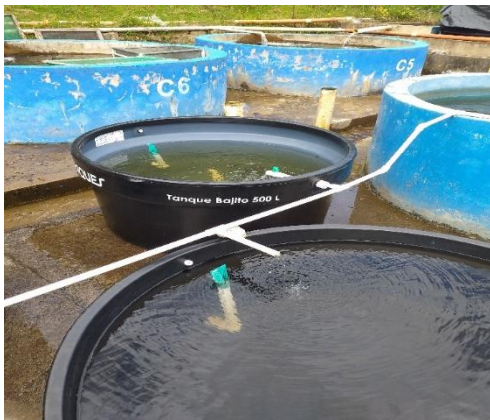
Figura 6. Detalles de sistema para ingreso individual.
